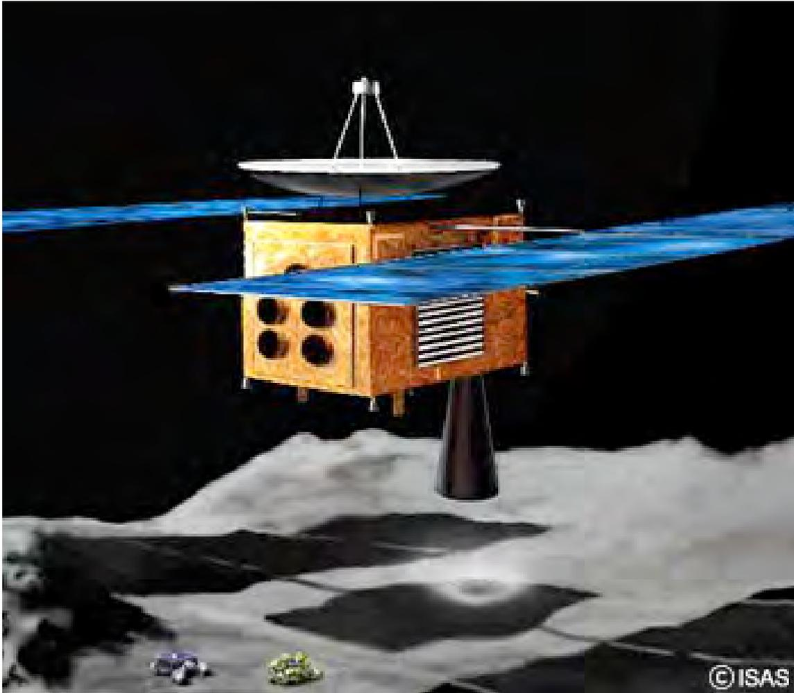
図2 ネレウス表面での試料採取の想像図 サンプル収集器のホーンが小惑星表面に接地し弾丸が発射され、探査機は上昇を始めた瞬間を示している。探査機の左側面には電気推進機の噴射口が4つ見える。またこれと反対側面（右向き）には収集したサンプルを収納して地球に帰還するカプセルの一部が見える。左下小惑星表面には探査機の降下目標となる人工標的物とマイクロローバーが見える。
