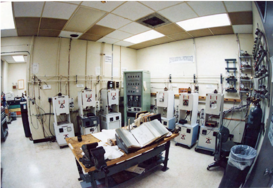
写真 3 電気炉の置いてある実験室のようす。この奥の部屋にさらに 6 台の実験炉がある。すべて酸素分圧がコントロールできる。
